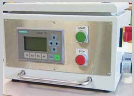
SBA Steuerbox automatik für zeitgesteuertes Einstichfinishen von Einzelteilen und Kleinserien
